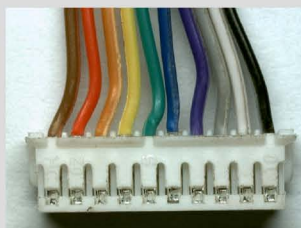
接插件线续检测
